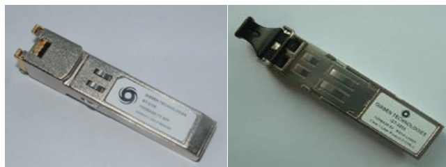
图 3-4 SFP 光电器件
